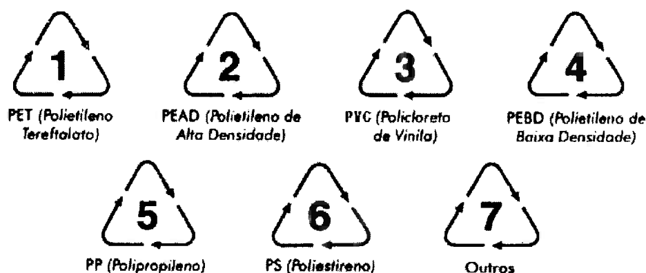
Figura 3.3.1 – Códigos utilizados em produtos plásticos a fim de permitir sua identificação imediata.
